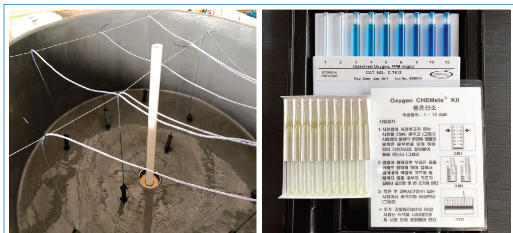
그림 23. 에어스톤 설치와 용존산소량 측정.
